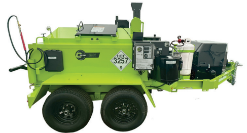
ME2 250 Gallon Mastic Melter Applicator
